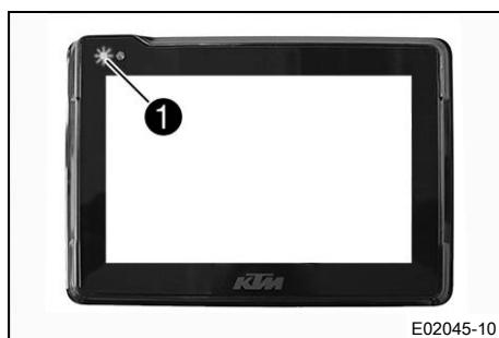
Kontrolka RACE ON **1** může blikáním signalizovat chybné funkce. Zobrazeny budou až pět sekund po stisknutí tlačítka RACE ON.
